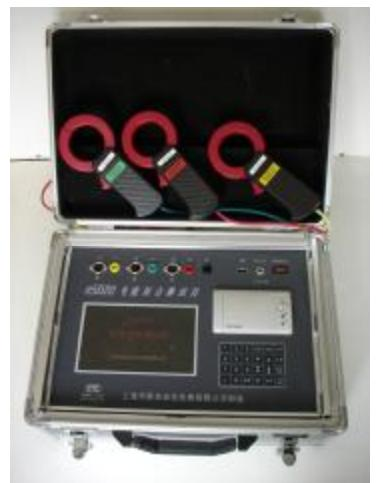
HSDZC 电能综合测试仪是本公司研制的便携式多功能电参数检测仪器，国产仪表的价格，超越进口仪表的功能。
